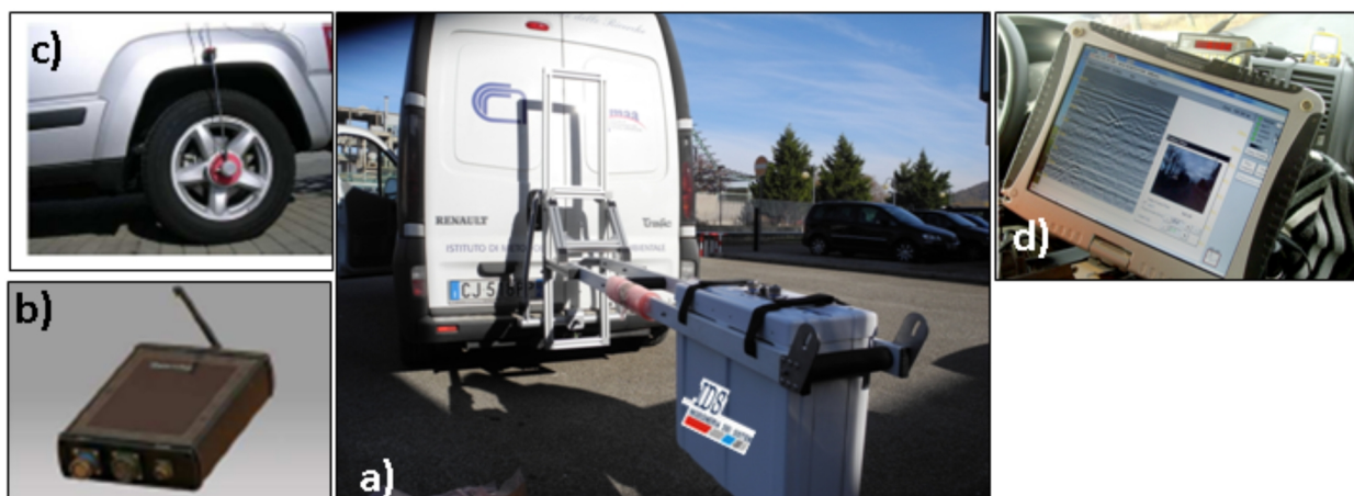
Figura 3- a) Sistema mobile con antenna Horn da 1 GHz; b) Digital Antenna Driver (DAD); c) odometro; d) PC portatile.
